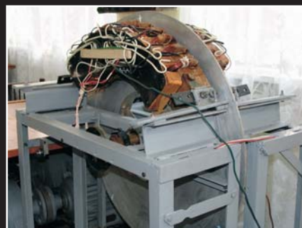
Standul experimental pentru acționarea electrică directă a unei instalații navale de guvernare activă.
