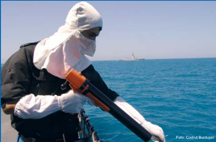
Lansarea dispozitivului de măsurare a condițiilor de propagare în apă (temperatura și salinitatea apei), pentru întocmirea prognozei de propagare a undelor sonarului în apă.
