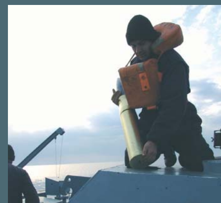
Încărcarea instalației artileristice calibru 100 mm, pentru tragere.
