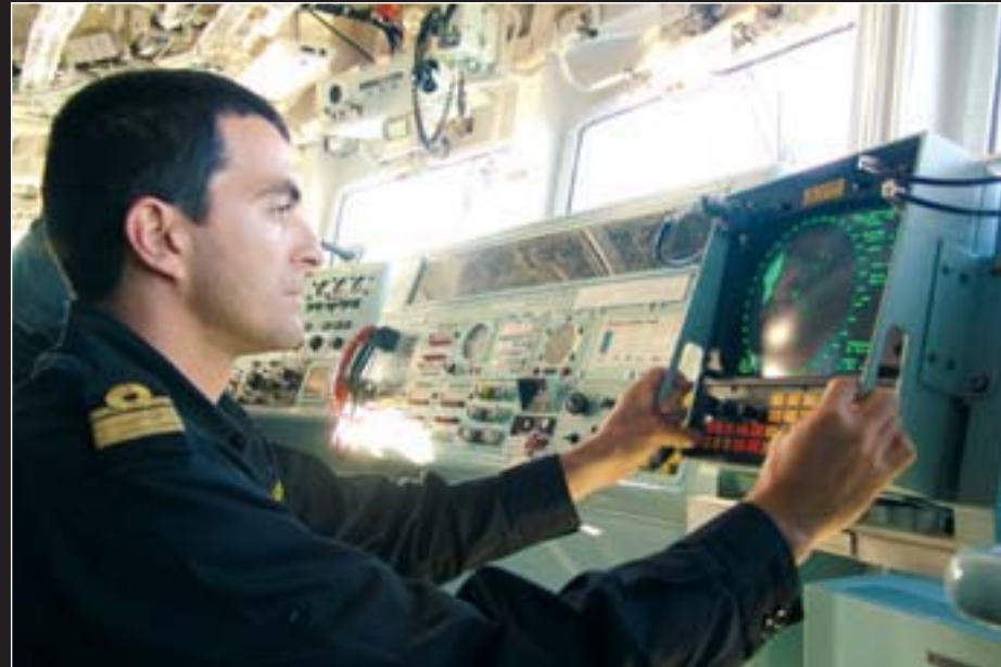
Locotenent-comandorul Marian Ciobotaru, șeful departamentului mentenanță, în timpul exercițiului de calibrare a radarelor prin metoda dublu-ecou.
