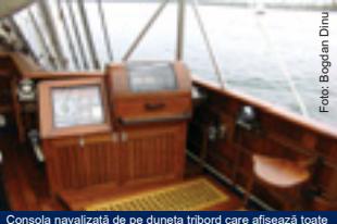
Consola navalizată de pe duneta tribord care afișează toate informațiile și indicatorii necesari navigației și conducerii navei.
