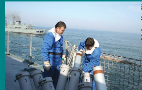
Instantaneu din timpul încărcării instalației Chaff MK36 calibrul 130 mm (în dreapta Mml Petrică Negoită).
