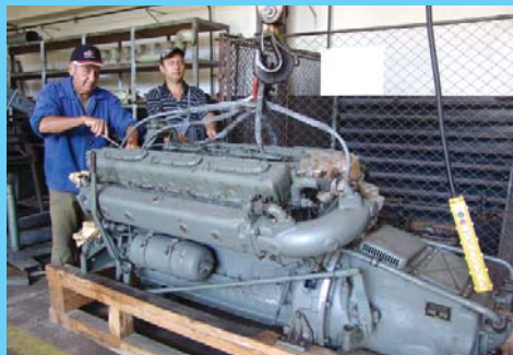
Secția a IV-a. Pcc Marin Fătu și SGV Nicolae Ghiu, motoristi. Lucrări de deconservare a unui motor înaintea montării la bord.
