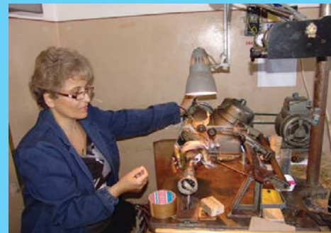
Secția a IV-a. Pcc Gabriela Pruli, bobinator în cadrul atelierului de mașini electrice speciale. Bobinează un transformator de impuls pentru stația de conducere a tragerilor de artilerie.
