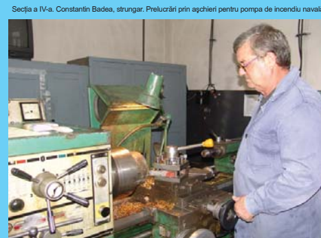
Secția a IV-a. Constantin Badea, strungar. Prelucrări prin așchieri pentru pompa de incendiu navală.
