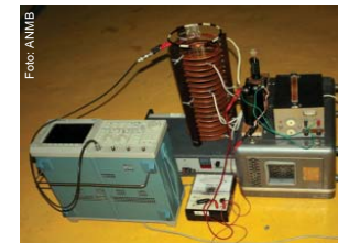
Dispozitivul de generare a unui puls electromagnetic într-o buclă de curent.
