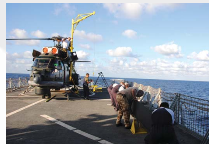
Demontarea palelor elicopterului
