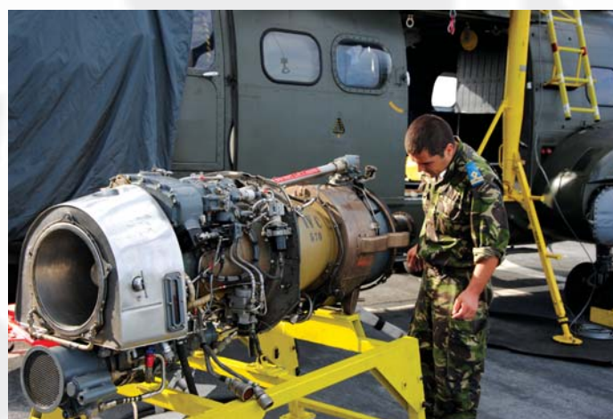
Motorul elicopterului scos pentru lucrări de mentenanță
