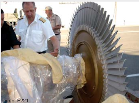
Foto: F221 Aspectarea noului rotor al turbinei de putere „Olympus”
