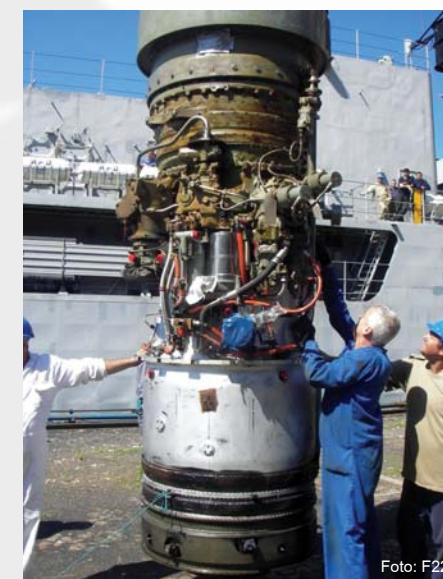
Demontarea generatorului de gaze al turbinei „Olympus”
