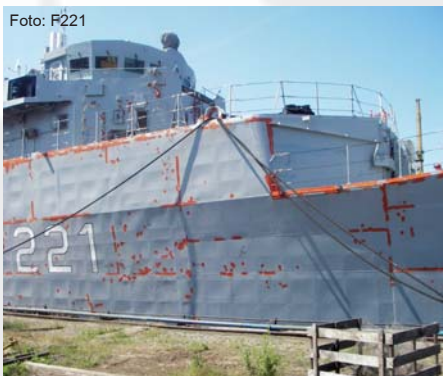
Foto: F221 Pregătirea bordajului navei pentru piturare
