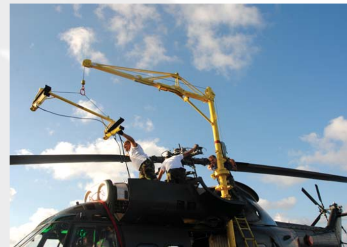
Aspect din timpul operațiilor de demontare a palelor elicopterului
