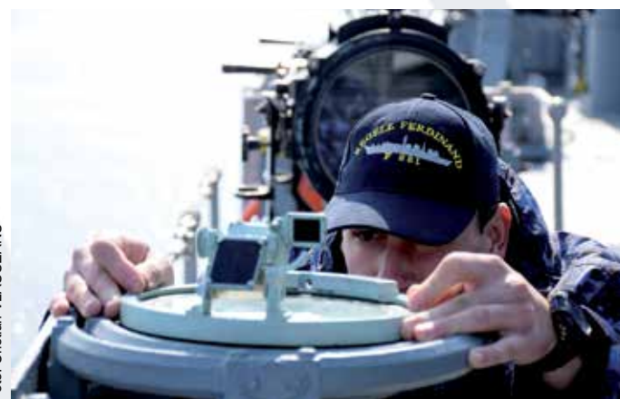
Verificarea relevmentelor la reperiile din schema de ieșire din port.
