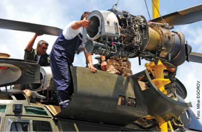
Lucrări de mentenanță la elicopterul Puma Naval, 2012.
